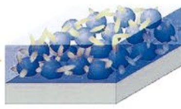
反応によりエポキシ骨格を主体とした塗布層が形成され、耐久性・耐水性に優れた塗膜となる
