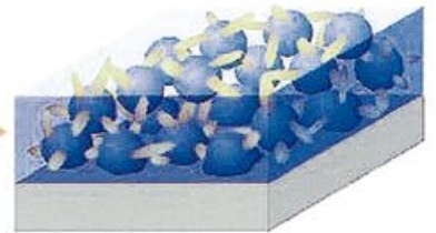
反応によりエポキシ骨格を主体とした塗布層が形成され、耐久性・耐水性に優れた塗膜となる
