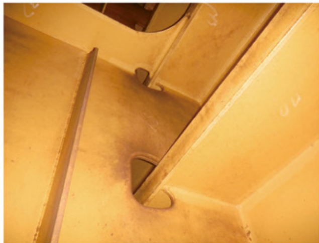
[仕様]NOA 60 HS バフ 350 \mu m [解説]80,820 DWT LNG船 塗装後、10年後の状態、発錆率0.01%以下(当社調査による)
