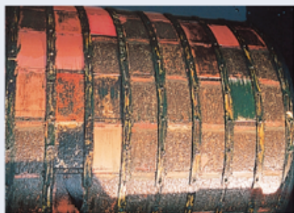
ドラムローターによる促進試験
